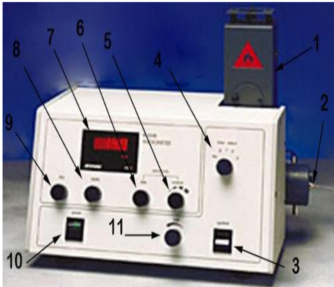
۱. مشعل ۲. محل ورود نمونه ۳. فندک (برای روشن کردن مشعل) ۴. تعیین عنصر مورد اندازه گیری ۵. تعیین نشر استاندارد (برای تغییر مقادیر بزرگ) ۶. تعیین نشر استاندارد (برای تغییر مقادیر کم) ۷. نمایشگر ۸. کالیبراسیون (نشر آب را صفر می کنیم) ۹. تغییر واحد نشر ۱۰. کلید پاور دستگاه ۱۱. تنظیم سوخت
